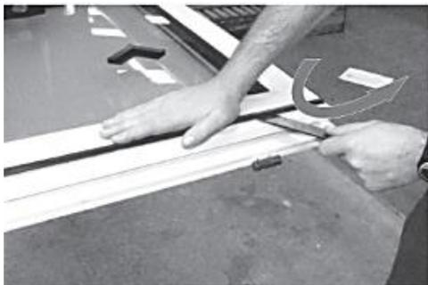
1. Glisser la clé entre le bois et l'aluminium, et déverrouiller les plots en les faisant tourner d'un quart de tour.
