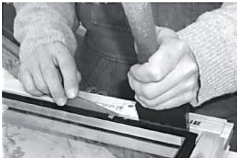
3. Mettre le panneau ou le vitrage en place, puis les cales avec l'aide d'une main de bois. Poser le cadre aluminium et reverrouiller les plots.
