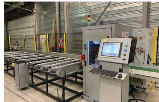
La MP2C 6000 d'Acra est destinée à la coupe et au perçage des profilés pour les moustiquaires.
