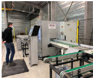
La MP2C 6000 d'Acra est destinée à la coupe et au perçage des profilés pour les moustiquaires.
