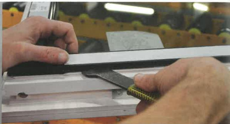
*Capotage de l'aluminium sur la fenêtre hybride de Minco*
