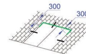
→ **POSE DES MEMBRANES EN TOITURE** sur toute largeur en partie haute avec 2 retombées de 300 mm
