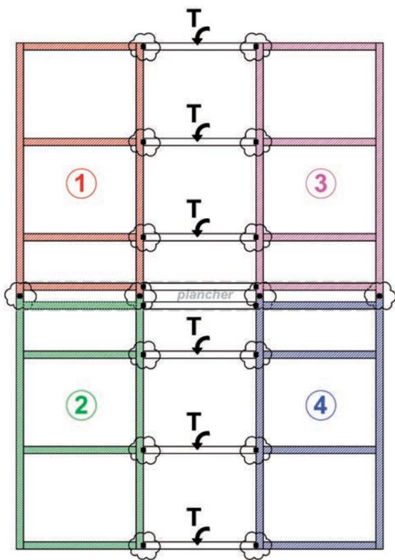
→ **4 ÉLÉMENTS LIVRÉS + 8 TRAVERSES EN FOURNITURE À MONTER** avec système d'assembleur sur chantier selon détail ci-dessous.
