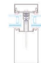
→ **PROFIL CHEVRON ALUMINIUM SYSTÉMATIQUE SUR STRUCTURE BOIS** pour récupération et drainage des eaux
