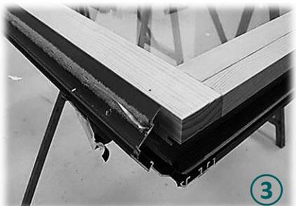
Démonter le profil chicane aluminium. Retourner le vantail côté aluminium.
